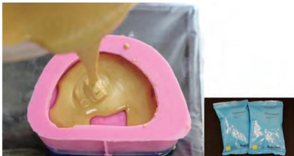
fig.9 耐火模型材の注入
