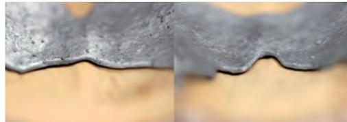
fig.43 サンドブラスト後の適合状態
