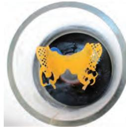
fig.40 埋没リングにパターンを植立した状態
