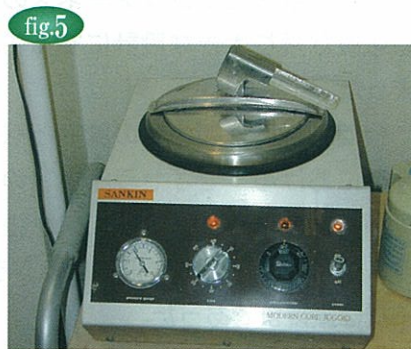
fig.5: 今回の実験に使用した加圧重合器。
